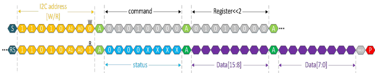
Диаграмма сигналов интерфейса I2C при чтении конфигурационных регистров.
